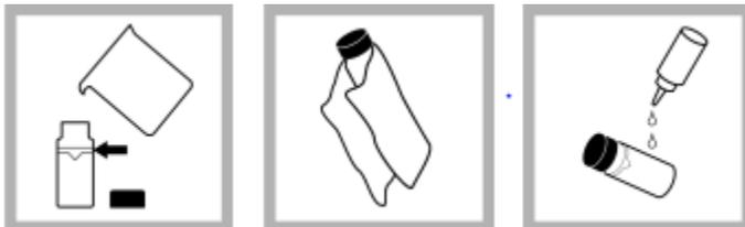
1. Recoger una muestra representativa en un recipiente limpio. Llene una celda de muestra hasta la línea (aproximadamente 15 ml). Tenga cuidado de manipular la celda de muestra por la parte superior. Tape la celda.
