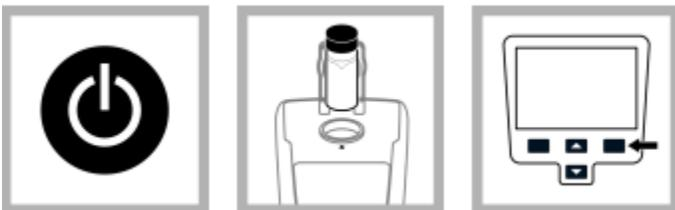
4. Presione la tecla *Encendido* para encender el medidor. Coloque el instrumento sobre una superficie plana y resistente. Nota: No sostengas el instrumento mientras tomas mediciones.
